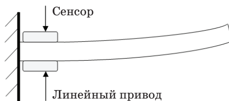
Рис. 1. Схема гибкой балки
